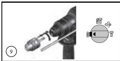
**9.** Use o conjunto de mandril SDS-Plus para tal aplicação. Para instalação, consulte "Instalação do mandril SDS-Plus" na página 10.
