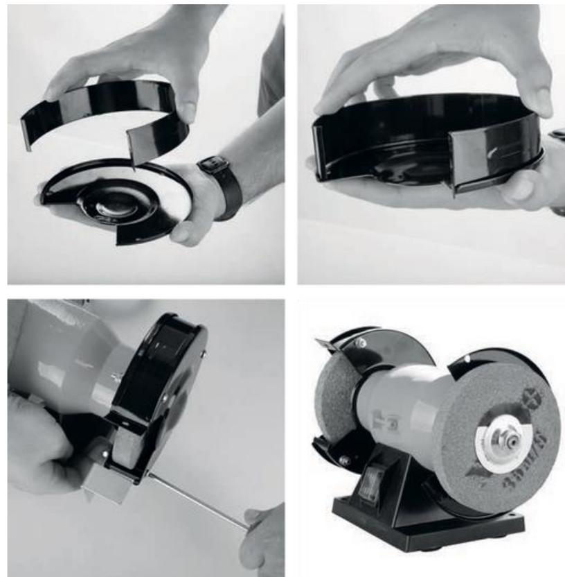
FIG. A - SUBSTITUIÇÃO DE UMA RODA DE ESMERILHAMENTO
